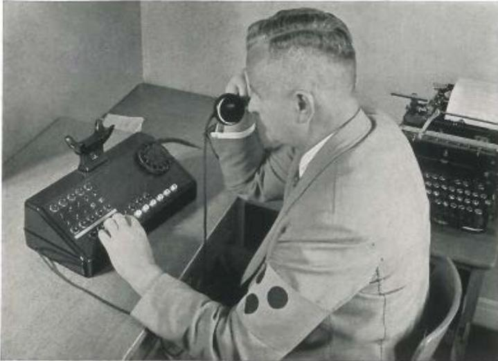
Neha-Anlage Typ 5/50. Ausgebaut z. Zt. mit 3 Amtsleitungen und 40 Nebenstellen.
